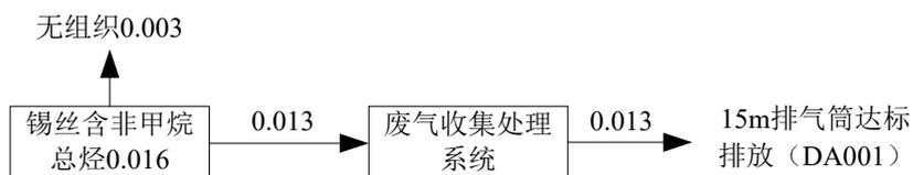
图 2.1-5 扩建项目锡焊工序非甲烷总烃平衡图 单位：t/a
