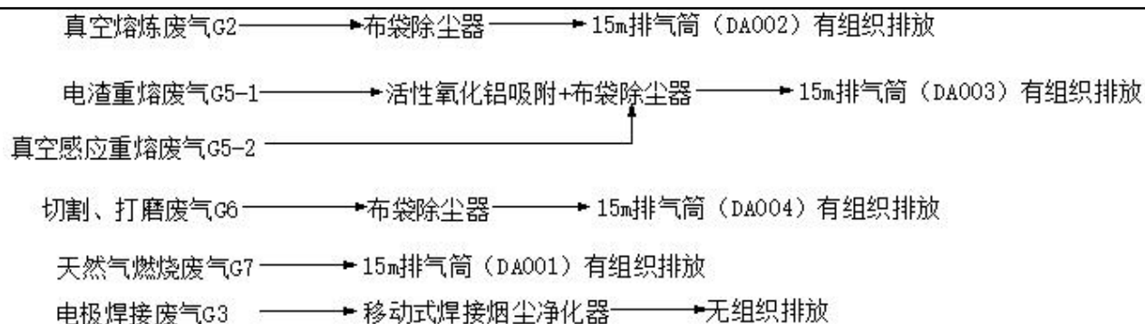
图 4.2-1 本项目废气治理设施示意图
