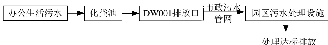
图 4.2.2-1 项目废水处理工艺流程图
